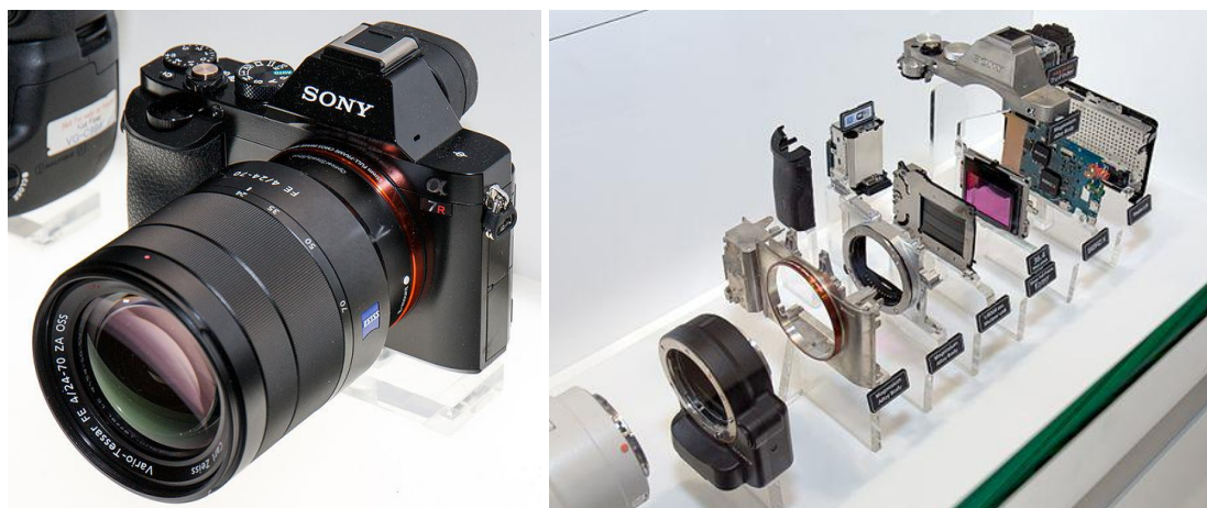
Рис. 1.1.13, 1.1.14. Цифровая камера «Sony Alpha ILCE-7R»: внешний вид и разобранное состояние
