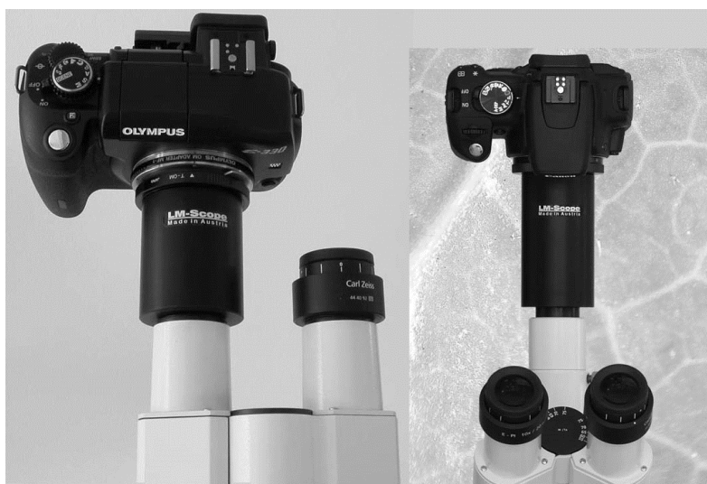
Рис. 5.6. Камера «Olympus» с универсальным адаптером «T-Mount» присоединен к оптическому микроскопу
