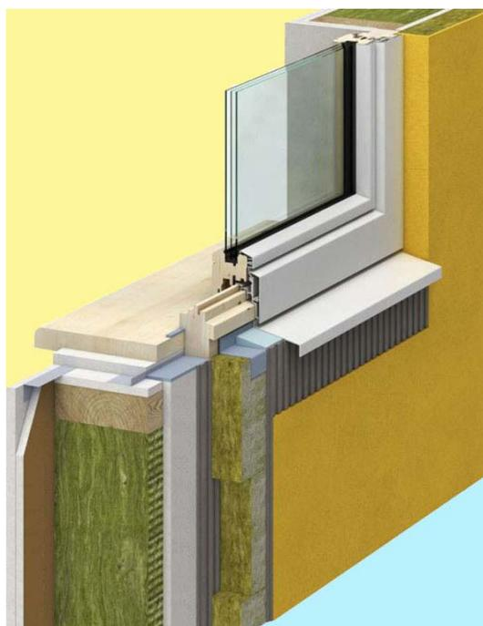
Рисунок 1.3.11 – Интеграция оконного блока в стену с деревянным внутренним каркасом
