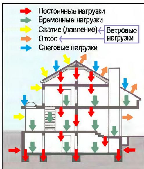
Рисунок 1.1.12 – Нагрузки на здание
