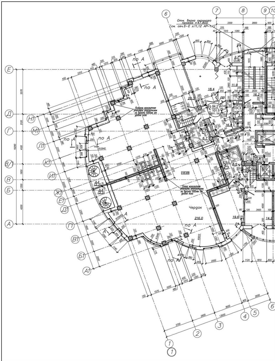
Рисунок 1.1.3 – Пример использования МКРС в случае высотного жилого комплекса «Славянский квартал» (фрагмент проектной документации), г. Минск
