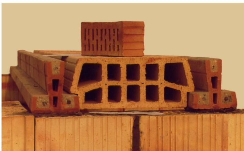
Рисунок 1.4.4 – Керамические элементы (тавровые балки с продольной арматурой, состоящие из коротких балочек-модулей для формирования балок длиной до 6300 мм, и многопустотные керамические вкладыши) сборно-монолитного балочного перекрытия (фото Д. Д. Жукова)
