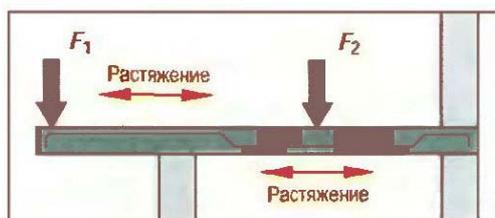
Рисунок 1.1.18 – Арматура в железобетонном перекрытии с консольной частью
