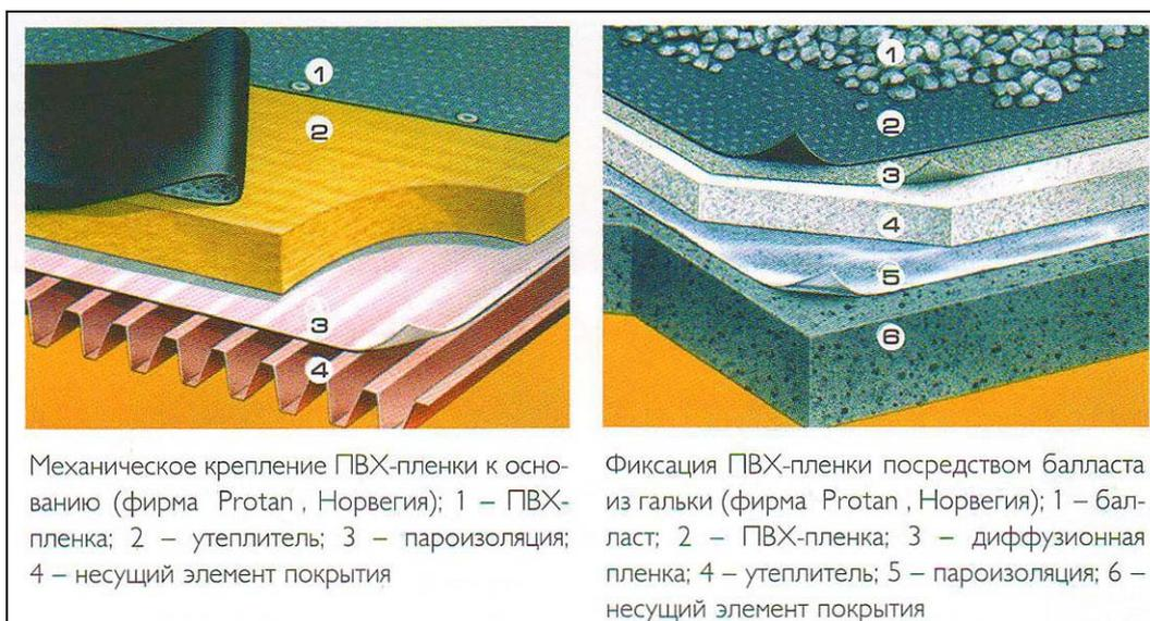
Рисунок 1.7.12 – Совмещенные кровли с прямым расположением слоев и водоизоляцией из полимерной мембраны
