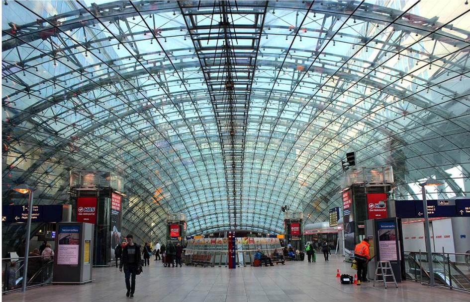
*Рисунок 1.6.6 – Спайдерное остекление в крупном мультифункциональном здании (интерьер), г. Франкфурт-на-Майне, Германия (фото Д. Д. Жукова)*
